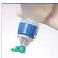
Flasche mit aufgesetzten Spike zur aseptischen Entnahme.
