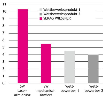
\* Höheres Maß der Bruchfestigkeit einer Nadel = mehr Sicherheit bei der OP.
